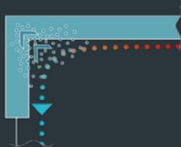
Ist die Luft wärmer als die Hüllflächen, kühlt sie sich an ihnen ab. Dadurch steigt die relative Luftfeuchte und es dringt Feuchtigkeit ins Mauerwerk ein.
