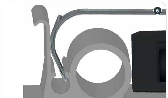
Die Sicherungsklammer wird am Kreuzungspunkt eingehängt...
