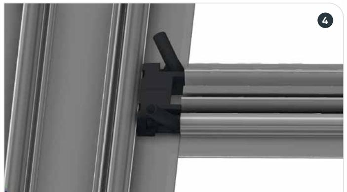
Das Nonius Unterenteil ES wird von oben eingeklickt oder kann seitlich eingeschoben werden, auch bei bereits montiertem Profilstück. Die Rasternase wird händisch abgebrochen und um 180° gedreht als Kreuzungspunkt verwendet.
