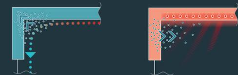
Ist die Luft wärmer als die Hüllflächen, kühlt sie sich an ihnen ab. Dadurch steigt die relative Luftfeuchte und es dringt Feuchtigkeit ins Mauerwerk ein.
