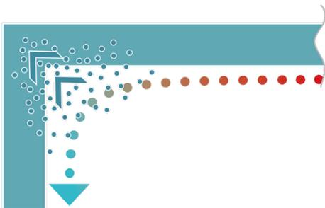
Ist die Luft wärmer als die Hüllflächen, kühlt sie sich an ihnen ab. Dadurch steigt die relative Luftfeuchte und es dringt Feuchtigkeit ins Mauerwerk.
