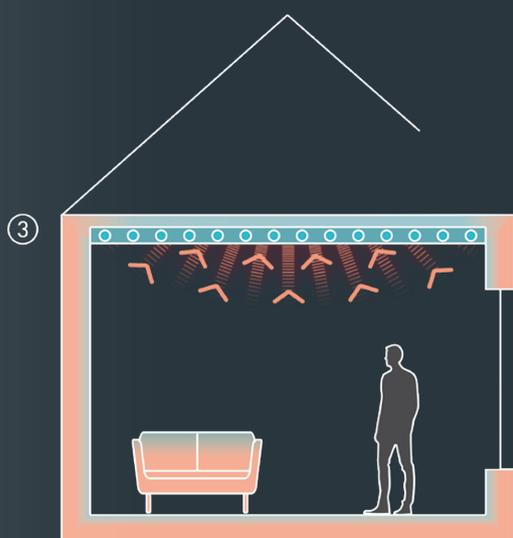
Die abgekühlten Oberflächen strahlen weniger Wärme in den Raum und erlauben dem Körper wieder eine behagliche Wärmeregulation, ohne zu schwitzen. Denn auch der Körper gibt seine überschüssige Wärme durch den Strahlungsaustausch an kühlere Oberflächen ab.
