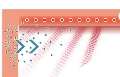
Ist die Luft kälter als die Hüllflächen, erwärmt sie sich an ihnen. Dabei verdunstet sie Wasser: Das Mauerwerk trocknet.
