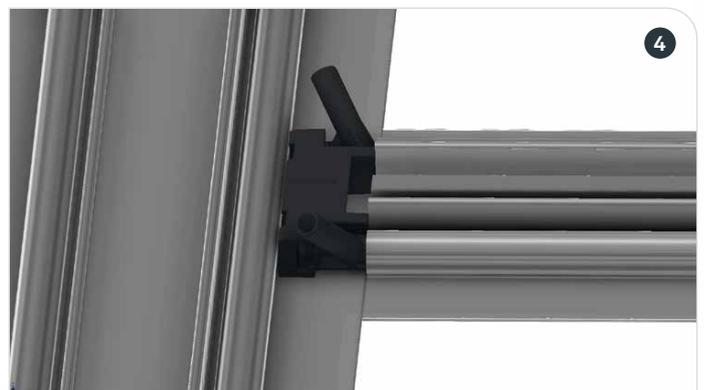
Das Nonius Unterteil ES wird von oben eingeklickt oder kann seitlich eingeschoben werden, auch bei bereits montiertem Profilstück. Die Rasternase wird händisch abgebrochen und um 180° gedreht als Kreuzungspunkt verwendet.
