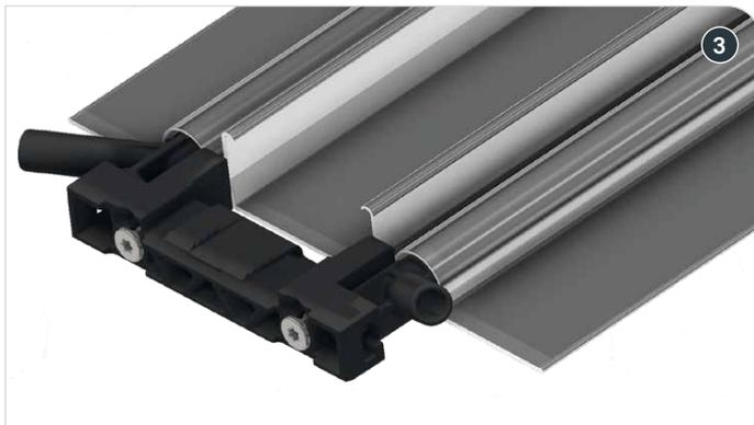
Das Nonius Unterteil ES wird von oben eingeklickt oder kann seitlich eingeschoben werden, auch bei bereits montiertem Profilendstück. Die Noniusabhängung muss lotrecht eingebaut werden.
