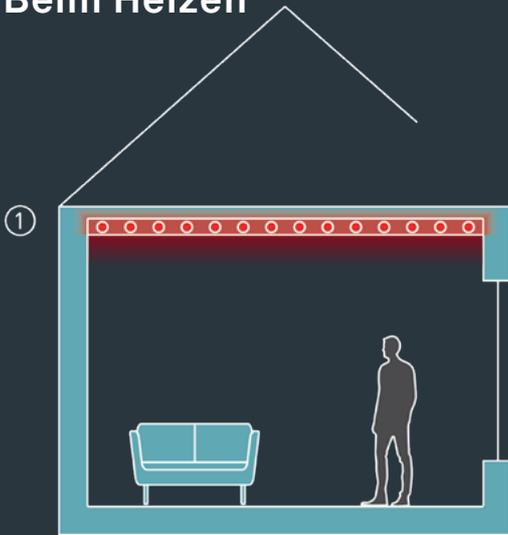
Warmes Wasser strömt durch Rohre in der Decke und beheizt deren Oberfläche. An der warmen Deckenoberfläche erwärmt sich die Luft.
