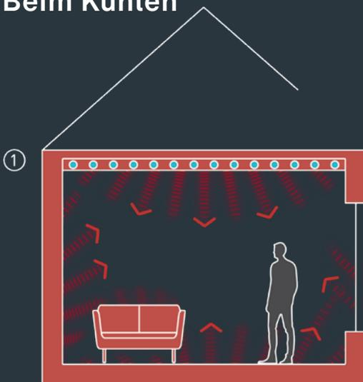
Sind die Oberflächen im Sommer aufgeheizt, strahlen sie viel Wärme in den Raum. Durch die Rohre der Klimadecke wird nun kaltes Wasser geleitet, um die Deckenoberfläche zu kühlen.
