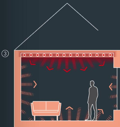
Alle Oberflächen sind nun wärmer als die Raumluft. Wie die Decke strahlen sie ihre Wärme sanft und gleichmäßig in den Raum.
