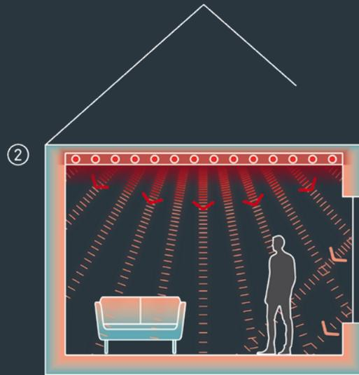
Die Warmluft kann an der Decke weder aufsteigen noch abkühlen: Die Konvektion ist ausgebremst. Wärme wird nur noch mit Wärmestrahlung an Boden, Wände und Möbel übertragen.
