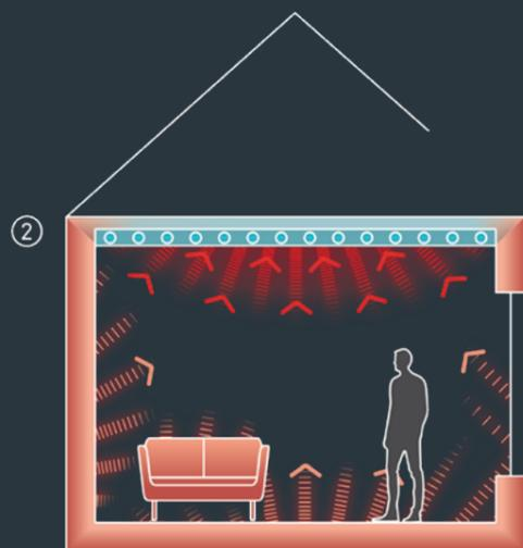
Die abgekühlte Deckenoberfläche absorbiert Wärmestrahlung aus dem Raum. Diese Wärme führt sie permanent mit ihrem Kühlwasser ab. Der Strahlungsaustausch zwischen der kühlen Decke und den warmen Oberflächen kühlt jetzt auch die Wände, den Boden und die Möbel.
