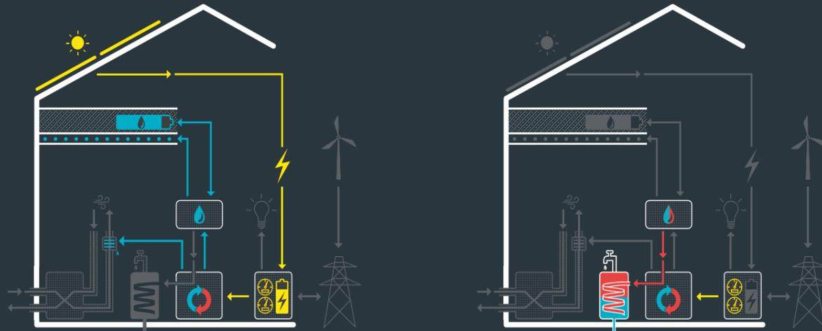
Im Sommer verwandelt die Wärmepumpe überschüssigen Strom in Kälte. Die Kälte wird im gedämmten Betonkern der Geschossdecke gepuffert. Zusätzlich führt die Wärmepumpe Wärme aus dem Gebäude ab und erzeugt Kälte für Klimadecke, Deckenspeicher und Lüftungsanlage.
