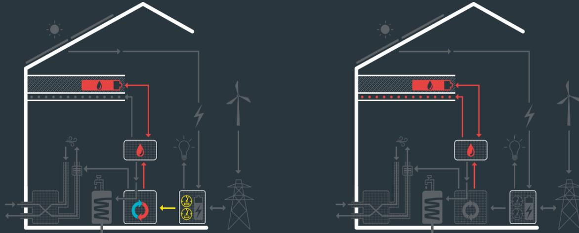
Im Heizbetrieb verwandelt die Wärmepumpe überschüssigen Strom in Wärme. Die Wärme wird im gedämmten Betonkern der Geschossdecke gepuffert.
